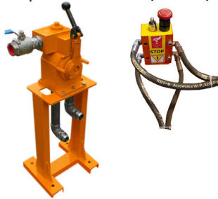
Mando con Parada de Emergencia Separados del Winche (5 metros)
